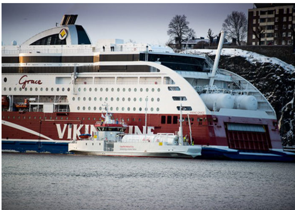
Figure 17. LNG Bunkering Ship "Seagas" alongside the Viking Grace
